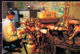
Appareil de spectroscopie de masse.
