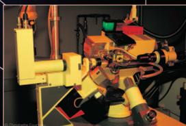
Appareil de diffraction des rayons X
