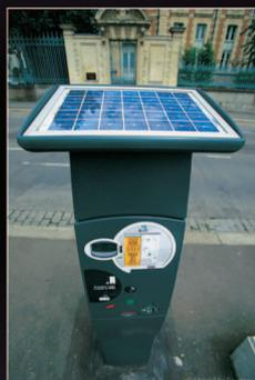
Le panneau photovoltaïque de ce parcimètre est un exemple d'alternative que la chimie propose aux sources traditionnelles d'énergie.
