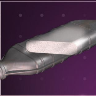
Dans un pot d'échappement, le catalyseur métallique est déposé à l'intérieur d'alvéoles et transforme les polluants en molécules moins toxiques.
