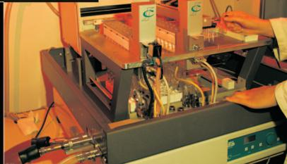
Véritable révélation technique, la chimie combinatoire permet de tester de façon automatique et en utilisant de petites quantités un très grand nombre de composés. En incrustation : recherche de molécules fluorescentes après réaction.
