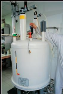
Sonde d'un appareil de résonance magnétique nucléaire.
